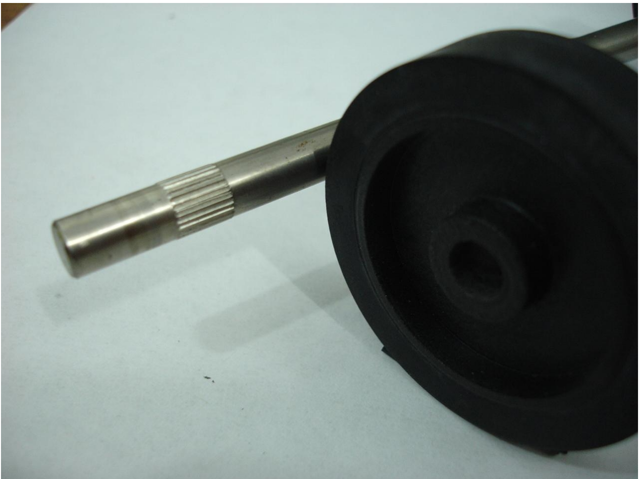
Eixo com segmento recartilhado axial
