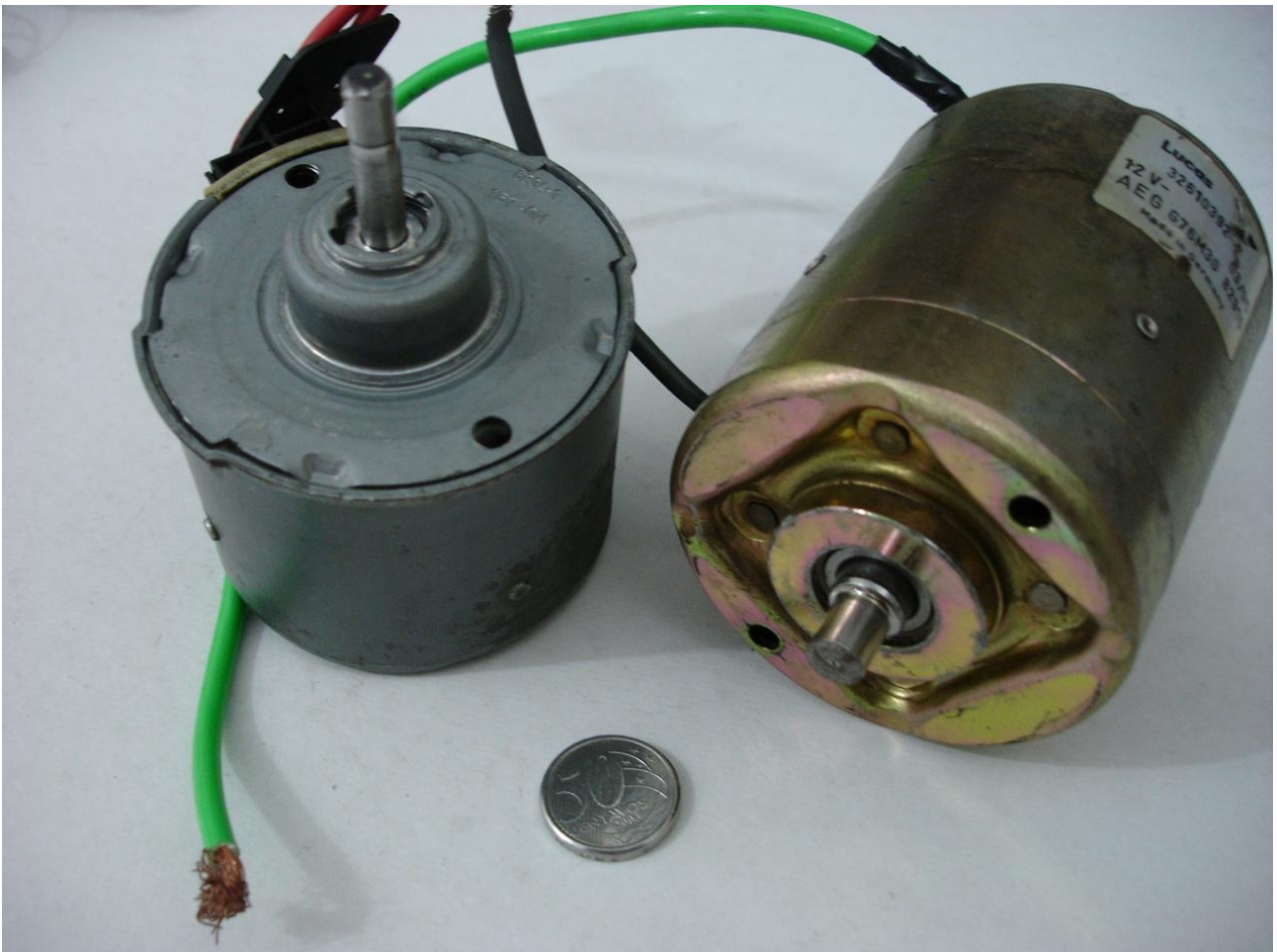
Motores de bomba hidráulica do freio ABS
