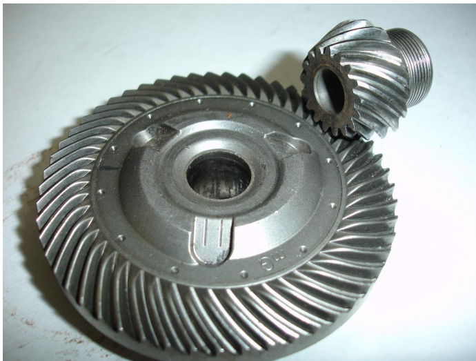
Engrenagem cônica com dentes helicoidais
